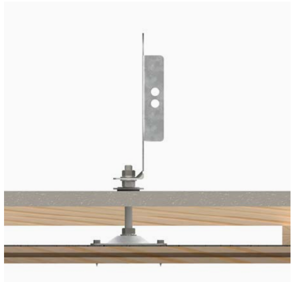
Borrade hål i släta betongpannor.
