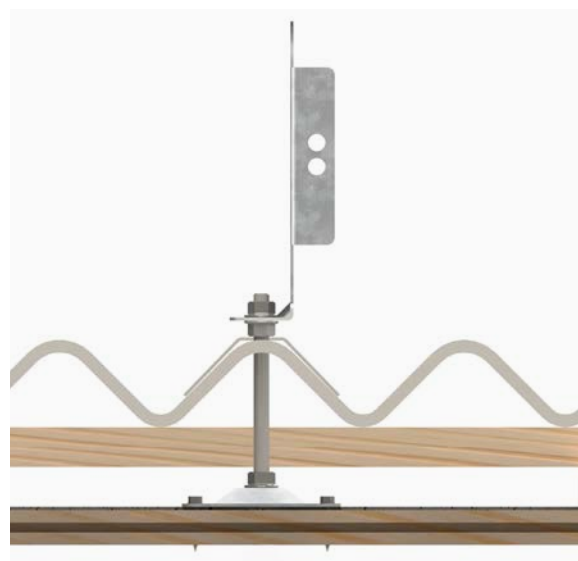
Infästning i fibercementtak.
