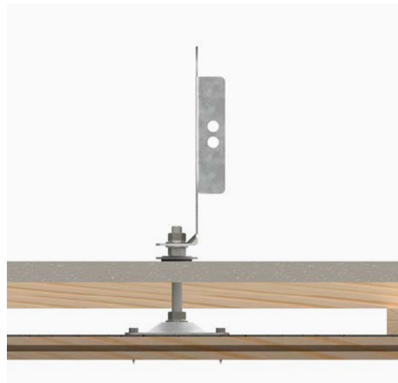
Borrade hål i släta betongpannor.
